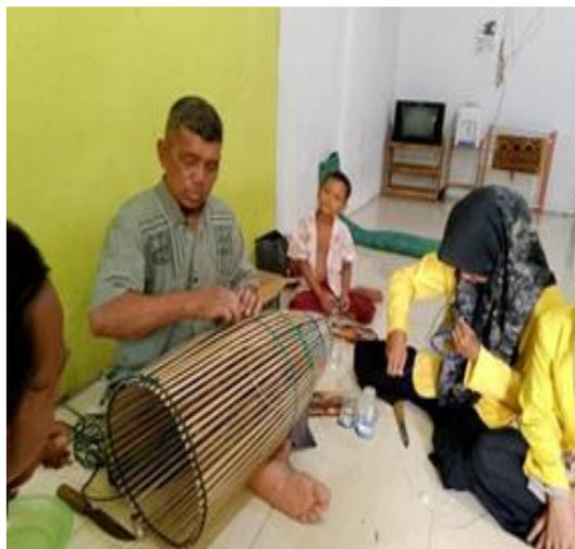
**Gambar 1.** Proses Pembuatan Bubu Ikan (Perangkap Ikan)
