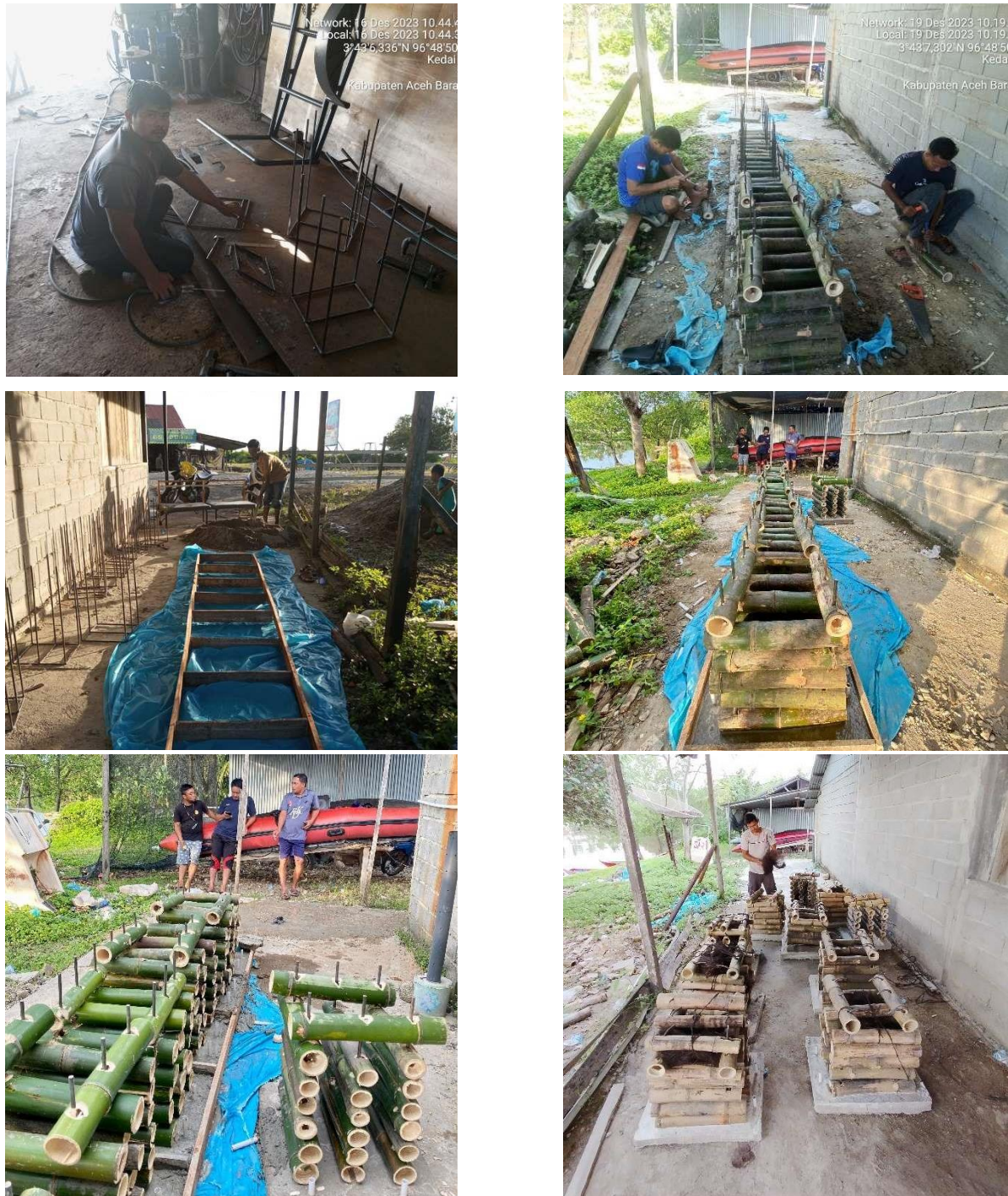
Gambar 3. Proses pembuatan media rumah ikan buatan yang dipadukan dengan media propagasi terumbu karang
