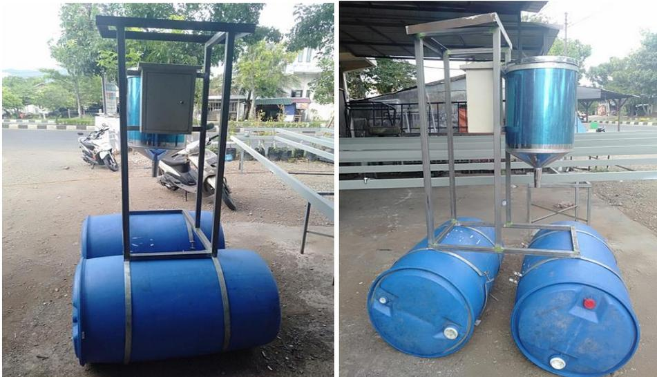
Gambar 3. Tampilan *Autofeeder* dan panel surya
