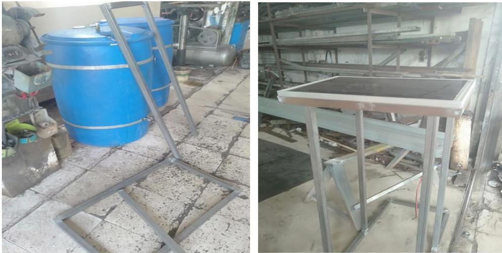
Gambar 2. Tampilan rangka *Autofeeder* dan panel surya masih dalam perakitan
