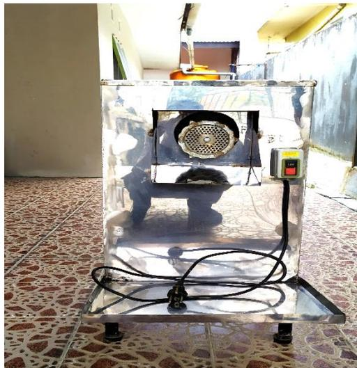
Gambar 3. Mesin penggiling ikan/*chopper* yang digunakan dalam proses produksi abon
