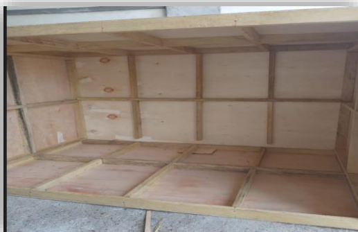
Gambar 3. Cetakan produk Ice Cool Box
