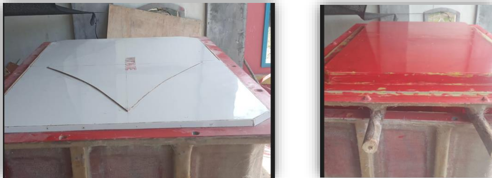
Gambar 5. Pola dan cetakan tutup Ice Cool Box
