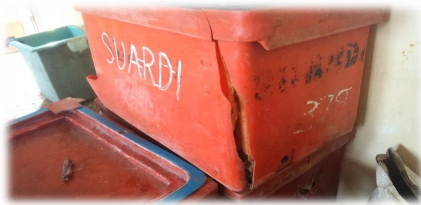
Gambar 1. Wadah penyimpanan ikan mengalami kerusakan efek pembebanan tinggi
