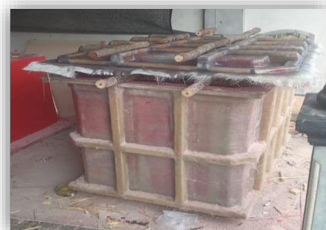
Gambar 3. Cetakan produk Ice Cool Box
