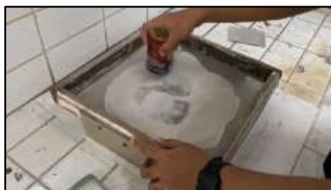
Gambar 4 Penyaringan Serbuk Kaca Menggunakan Ayakan No. 200
