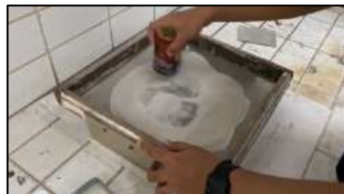
Gambar 4 Penyaringan Serbuk Kaca Menggunakan Ayakan No. 200
