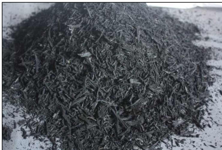
Gambar 1. Serat ban bekas yang telah diayak di laboratorium Sumber : Penulis
