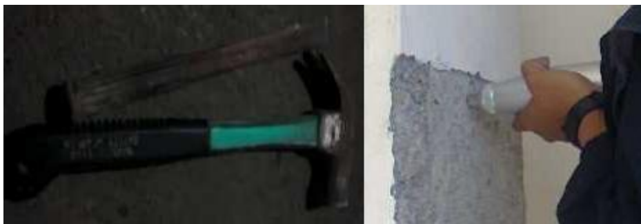
Gambar 3 : Peralatan Concrete Hammer Test dan aplikasi pengujian di lapangan Sumber : Penulis
