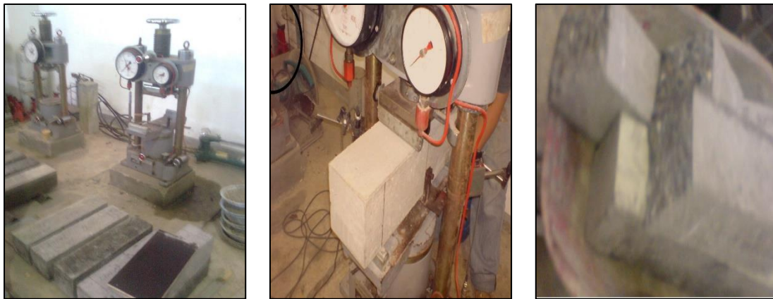
Gambar 6. Pengujian Kuat Lentur Balok Beton 15 x 15 x 60 cm
