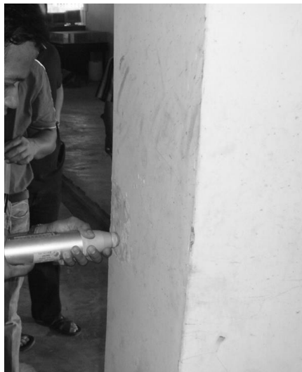
Gambar 4. Posisi pengujian hammer
