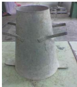
Gambar 2. Kerucut Abrams diameter atas 10 cm dan bawah 20 cm serta tinggi 30 cm
