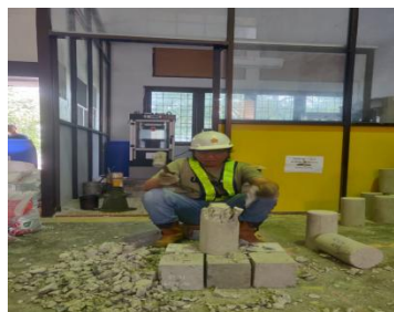
Gambar 1. Penghancuran beton untuk substitusi agregat kasar
