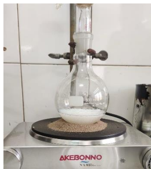
Gambar 1 Alat pelunakan polypropylene (PP) dengan metode refluks (dokumen penelitian)
