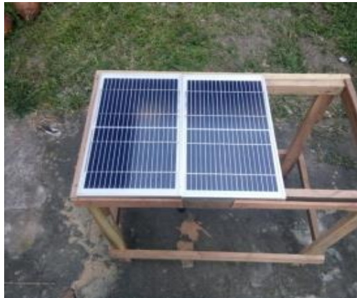
Gambar 5. Modul Surya terpasang pada Frame
