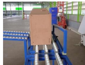
(f) Perubahan Posisi Conveyor Menjadi Miring Secara Otomatis
