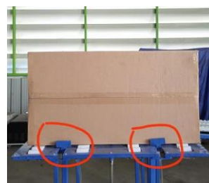
(c) Mekanisme Pendorong Karton ke Roller Conveyor
