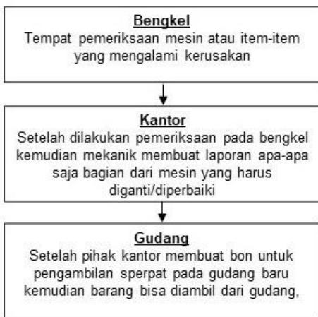
**Gambar 1.** SOP penggantian komponen pada PDAM Tirta Montala
