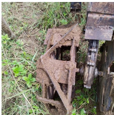
Gambar 14. Kondisi roda penggerak setelah dilakukan pengujian di lahan sawah.
