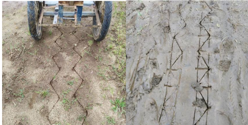
(a) Tampak jejak roda pada tanah kering (b) Tampak jejak roda pada lahan sawah Gambar 13. Tampak jejak roda penggerak tipe buka tutup
