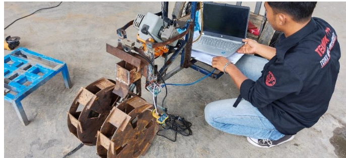
Gambar 9. Pemasangan notebook untuk pemrograman arduino uno
