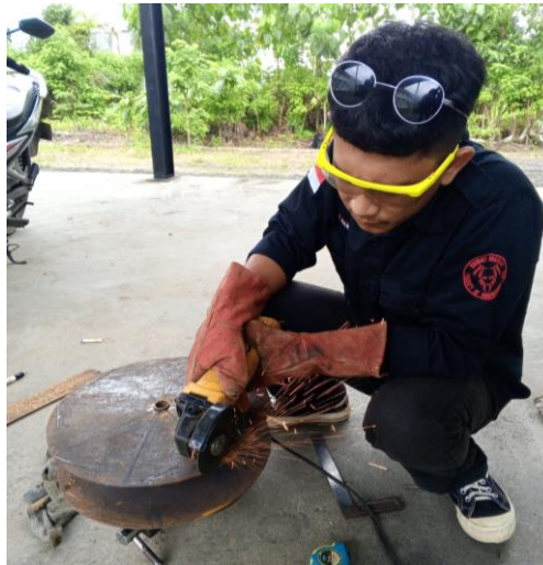
Gambar 5. Pemotongan alur sirip roda
