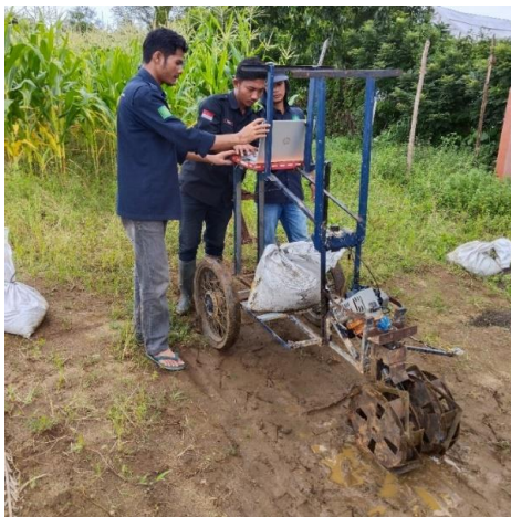
Gambar 12. Pengaturan dan kalibrasi perangkat sensor pengukuran
