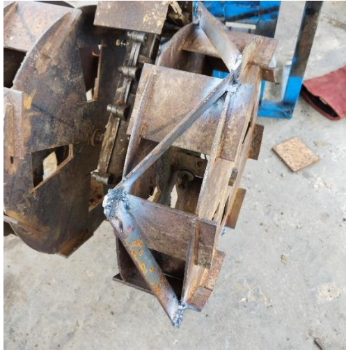
Gambar 11. Roda penggerak tipe buka tutup yang telah dimanufaktur
