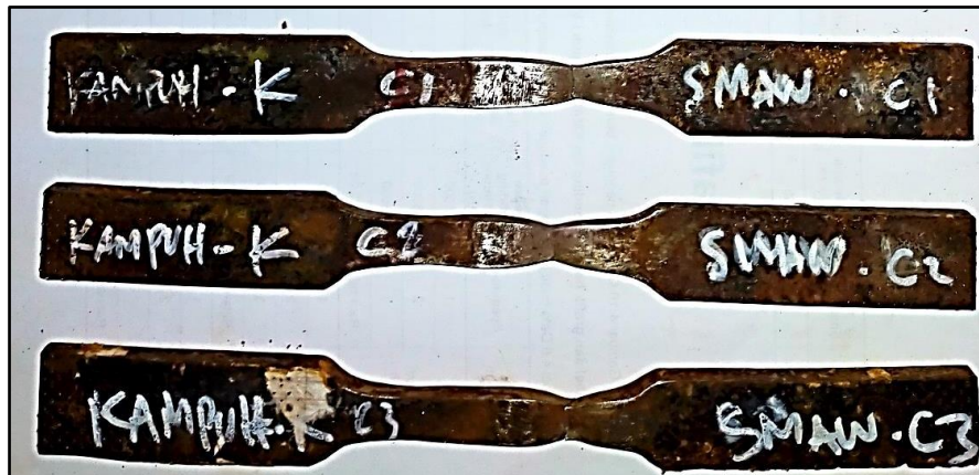
Gambar 9. Hasil pengujian tarik kampus K
