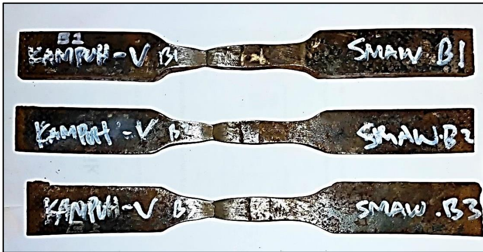
Gambar 7. Hasil pengujian tarik Kampuh V
