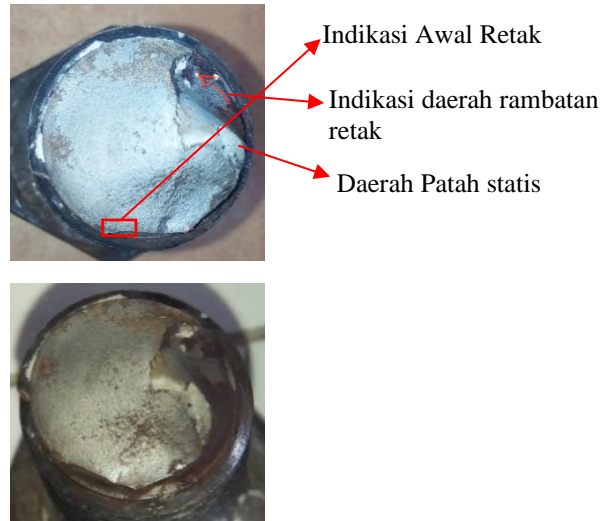
Gambar 5. Permukaan Patahan Baut
