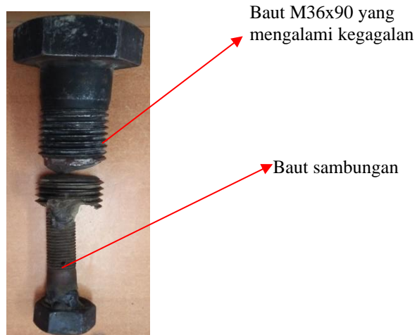
Gambar 4. Baut M36x90 yang mengalami kegagalan, sisa baut masih menempel pada baut lain karena proses pengeluaran baut.
