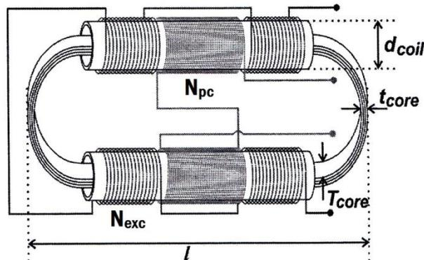
Gambar 2. Elemen sensor magnetik fluxgate dengan kumparan ganda.
