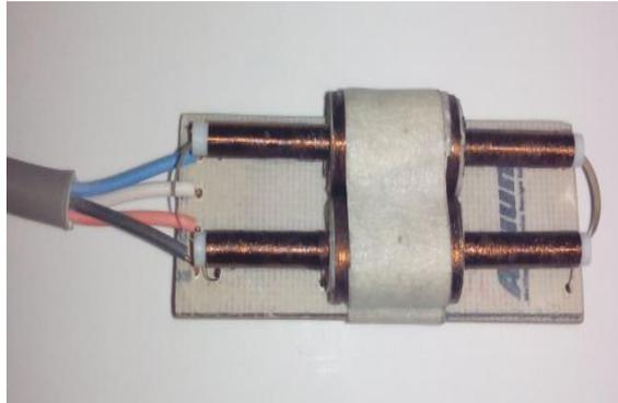
Gambar 3. Bentuk sensor magnetik fluxgate dengan inti ganda.
