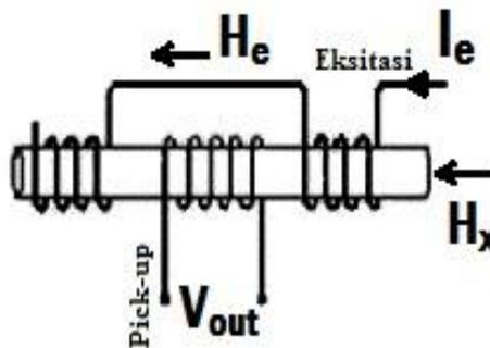
Gambar 1. Bentuk sederhana elemen sensor magnetik fluxgate.
