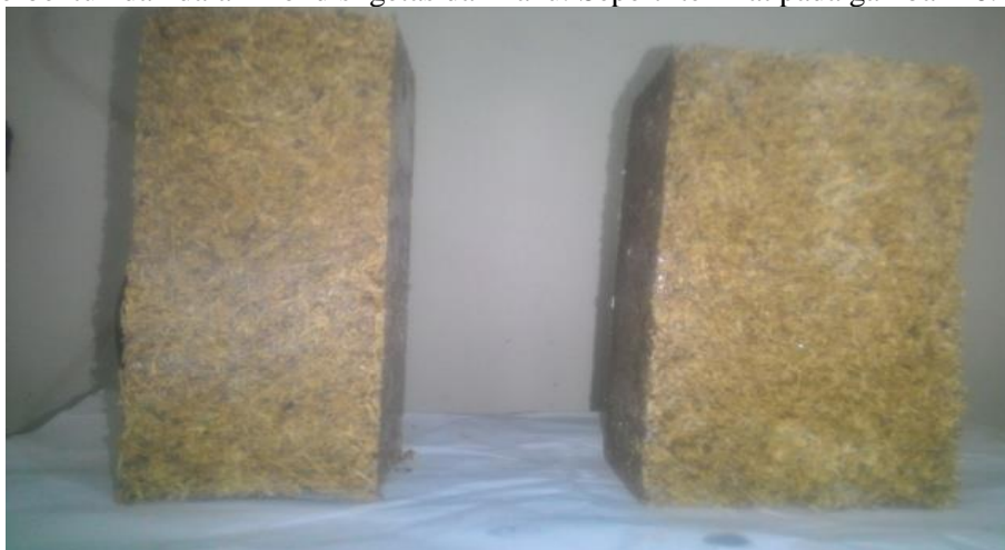
Gambar 16 : hasil akhir dari pembuatan balok serat komposit
