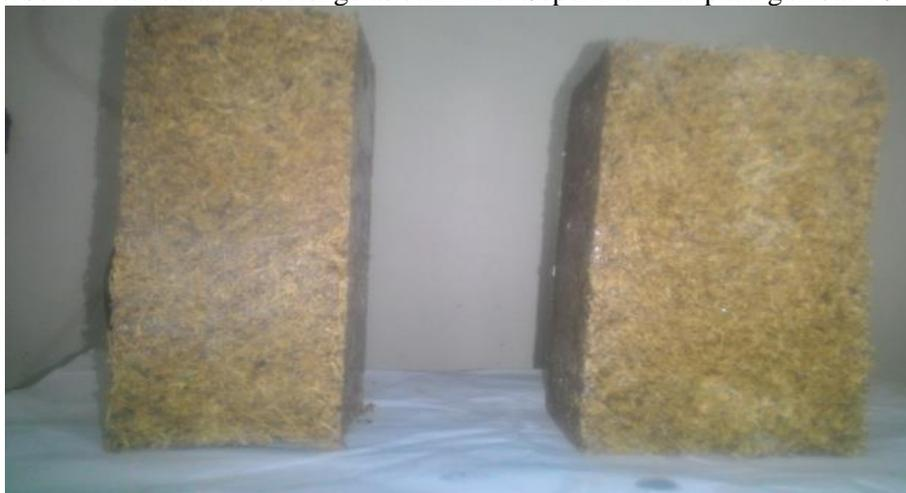
Gambar 16 : hasil akhir dari pembuatan balok serat komposit
