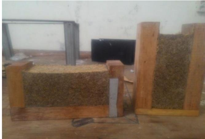
Gambar 15 : proses pembukaan cetakan.
