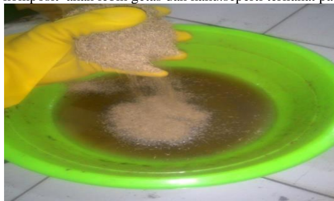
Gambar 12: Pengadukan serat dengan katalis dan resin
