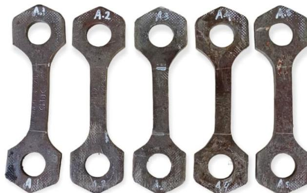
Gambar 4. Bahan setelah di uji Tarik Pembebanan 4 Ton
