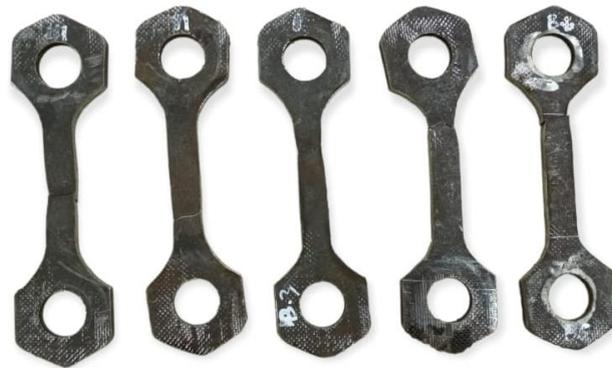
**Gambar 6.** Gambar Bahan Setelah Uji Tarik Pembebanan Maksimum
