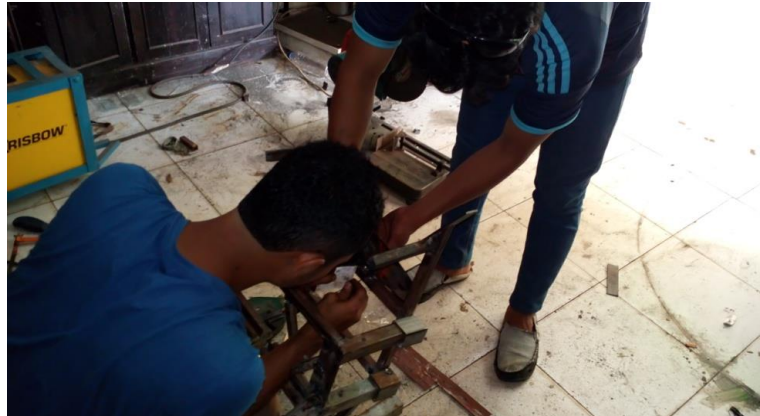
Gambar 4. Proses pembuatan gagang kendali mesin
