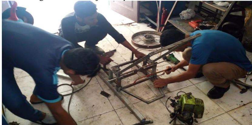
Gambar 2. Proses manufaktur rangka rumah mesin panen padi
