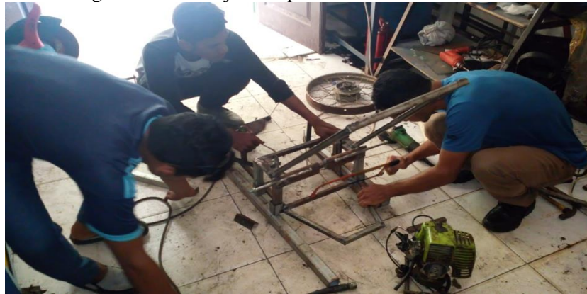
Gambar 2. Proses manufaktur rumah mesin panen padi
