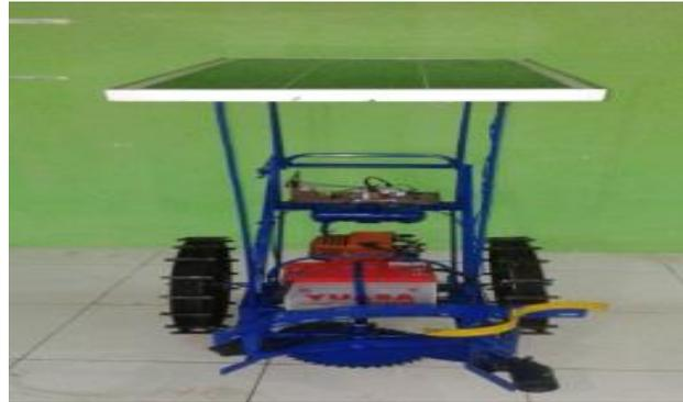
Gambar 10. Hasil Manufaktur mesin pemotong padi multifungsi
