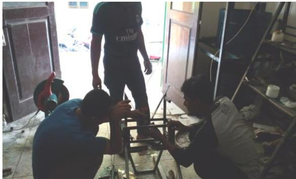
Gambar 8. Proses pembuatan dudukan mata potong
