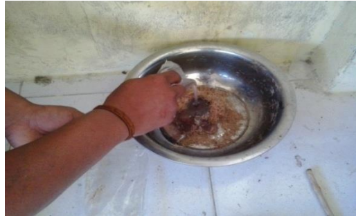
Gambar 5. Campuran polyester resin tak jenuh dengan serat Polyester resin tak jenuh dan serat tandan kosong kelapa sawit yang dipergunakan dalam proses pencampuran yang dilakukan dalam sebuah wadah.
