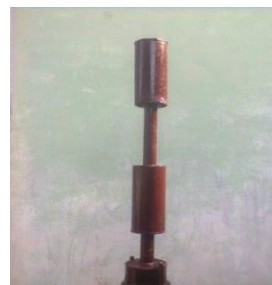
Gambar 5 b Hasil pembuatan pipa penghubung dan pipa penadah uap
