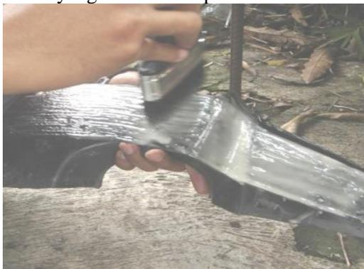
Gambar 7 pengerjaan hand lay up
