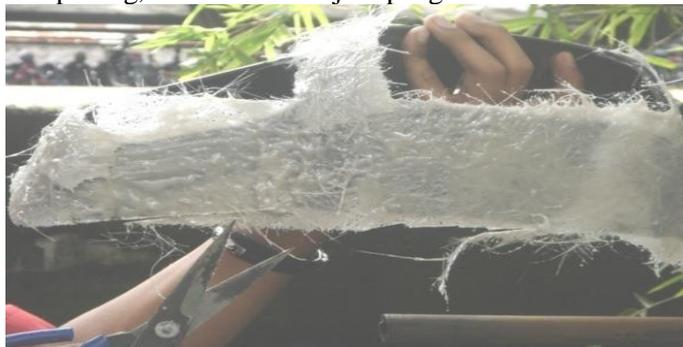
Gambar 11. Pemotongan serat pada tepi cetakan
