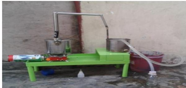
Gambar 9. Alat Penghasil Bioetanol Skala Prototype
