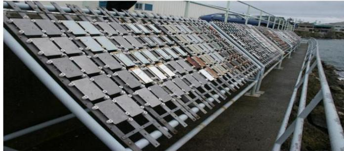
Gambar 1. Spesimen yang diekspos diatas rak pengujian dalam suatu pelaksanaan uji ekspos korosi atmosferik [11]
