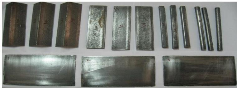
Gambar 2. Spesimen Uji laju korosi atmosferik
