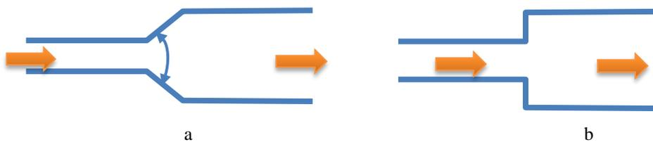
Gambar 2. Pembesaran penampang; a sudut ekspansi, ( $\alpha = 60^\circ, 120^\circ$ ) dan b. pembesaran tiba-tiba
