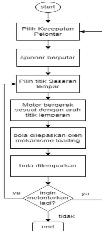
Gambar 3. Alur kerja sistem keseluruhan.
