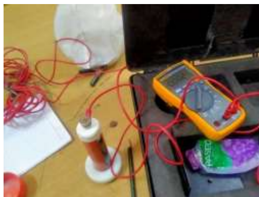
Gambar 5 Digital Half-Cell Potential Meter yang digunakan
