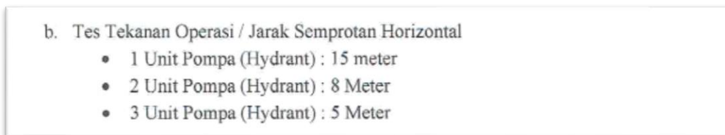
Gambar 4. Capture Berita Acara Pengujian (Tes Tekanan)
