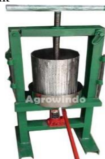
Gambar 4. Mesin Pemerasan Santan Sistem Hidrolik [9]
