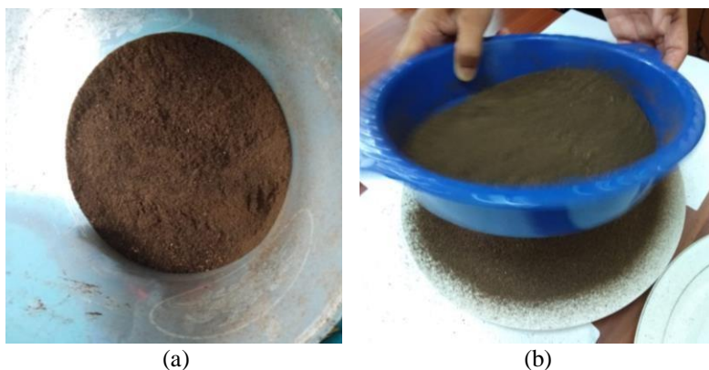
Gambar 7. (a) Bubuk kulit pisang keluar dari mesin, (b) penyaringan dengan saringan 625 mesh
