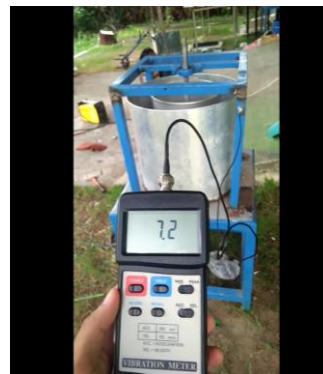
Gambar 2. Proses pengukuran tingkat getaran kerangka tabung mesin peras santan
