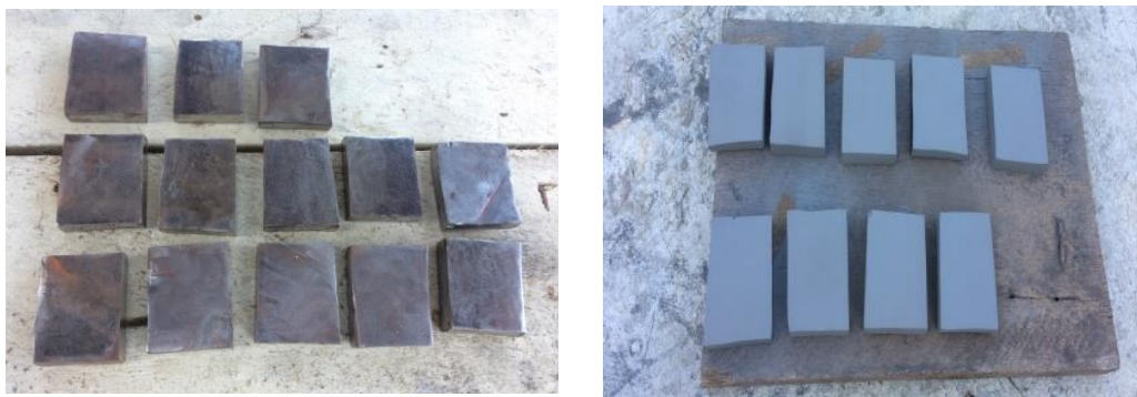
Gambar 1. Preparasi Spesimen Uji ASME SA 283
