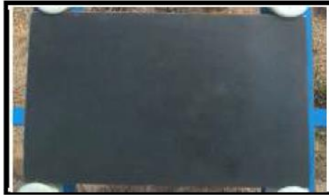
Gambar 6. Spesimen uji baja karbon rendah
