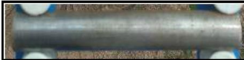
Gambar 4. Spesimen uji baja silinder
