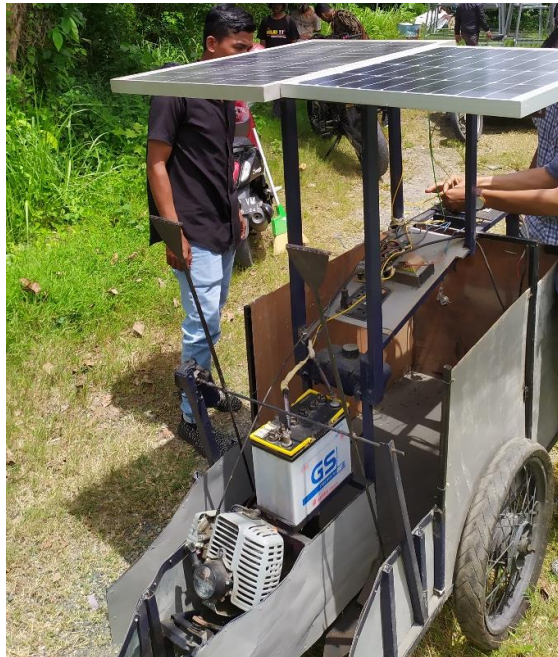
Gambar 5. Pengukuran kuat arus dan tegangan menggunakan dua panel surya
