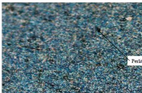
Gambar 3.3. Struktur Mikro BAJA AISI 4140 tanpa perlakuan
