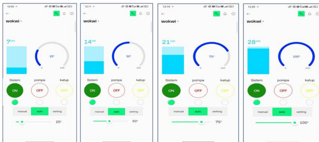
Gambar 6. Tampilan Dashboard Aplikasi Blynk pada Set Point 25%, 50%, 75%, dan 100% pada Mode Otomatis
