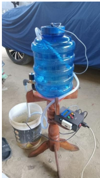
Gambar 5 Hasil perancangan prototipe sistem kontrol dan monitoring tangki air
