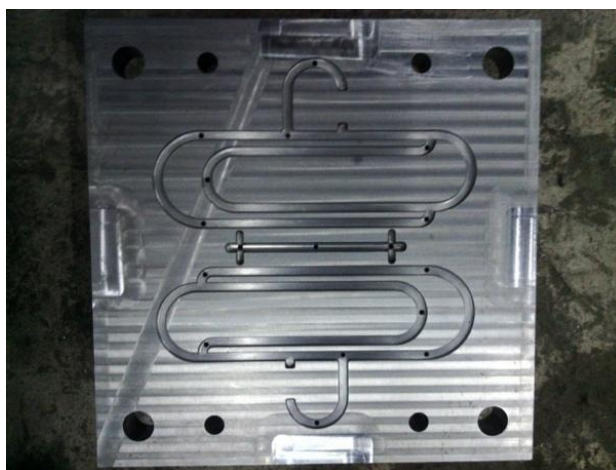
Gambar 2. Mold (Cetakan) yang Digunakan pada Proses Injection Moulding
