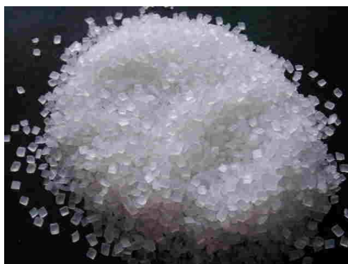
Gambar 1. Pelet Polipropilena sebagai Bahan Baku
