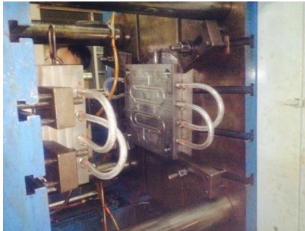
Gambar 3. Proses Injeksi Polipropilena ke dalam Mold
