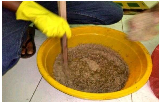
Gambar 12 Pengadukan Serat dengan Resin
