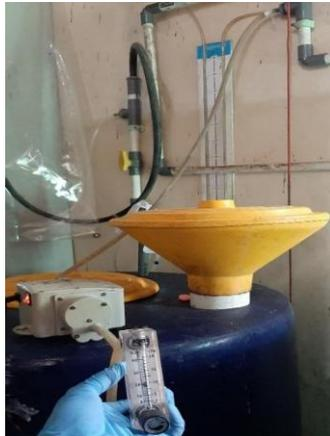
Gambar 2 Pengukuran Volume Biogas
