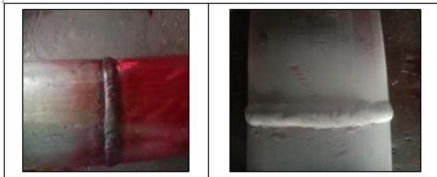
**Gambar 3** Sampel Sebelum Pengujian Tarik
