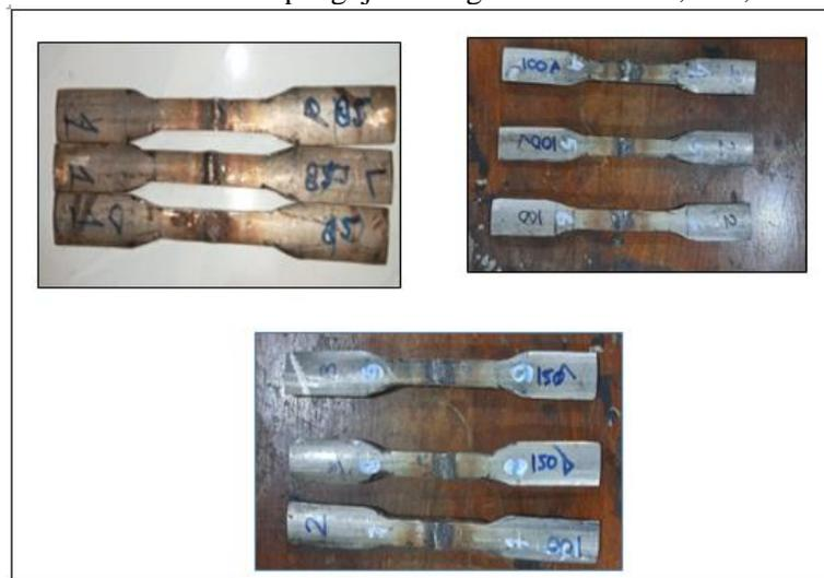
**Gambar 6** Sampel Sebelum Pengujian Tarik
