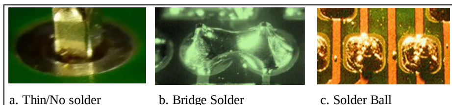
Gambar 2 Cacat Hasil Penyolderan
