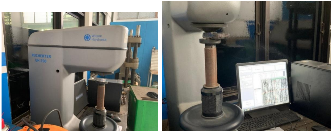
Gambar 2. Mesin uji kekerasan Vickers dan posisi sampel material silinder liner
