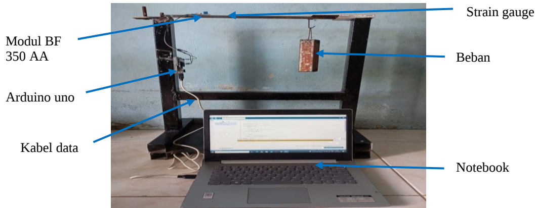
Gambar 2. Perangkat alat uji regangan menggunakan strain gauge berbasis arduino uno
