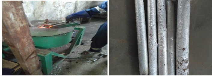
Gambar 1. a. Scrab chips alumunium 6061, b. Cetakan pasir, c. Furnace sederhana, d. Hasil coran.
