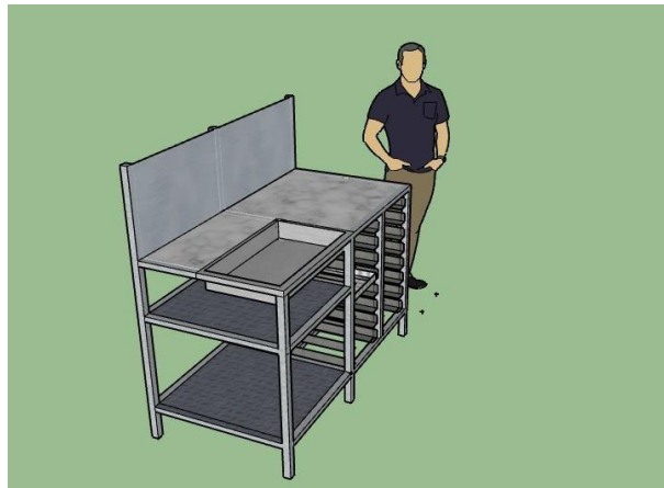
Gambar 10. Perancangan Usulan Fasilitas Meja Kerja Penggorengan Tampak Samping
