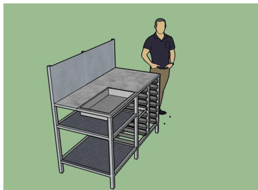
Gambar 8. Perancangan Usulan Fasilitas Kerja Operator Penggorengan
