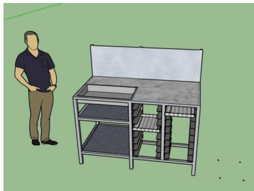
Gambar 8. Perancangan Usulan Fasilitas Kerja Operator Penggorengan
