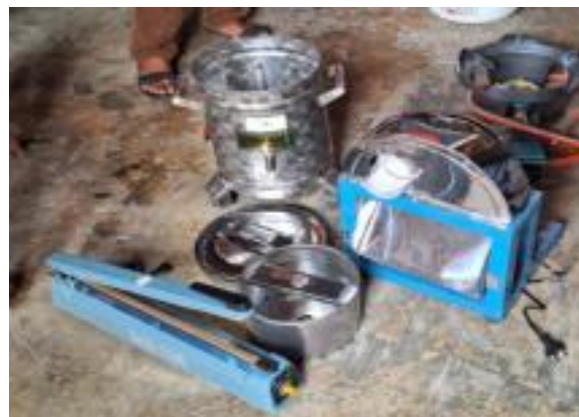
Gambar 4. Mesin Pengiris Singkong, Mesin Spinner Peniris Minyak, dan Mesin Sealer
