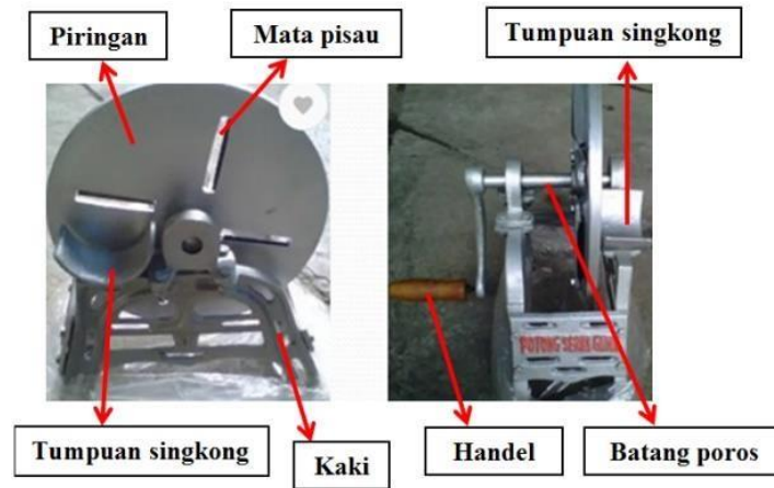
Gambar 9. Bagian-Bagian Alat Perajang Singkong tipe Rotasi
